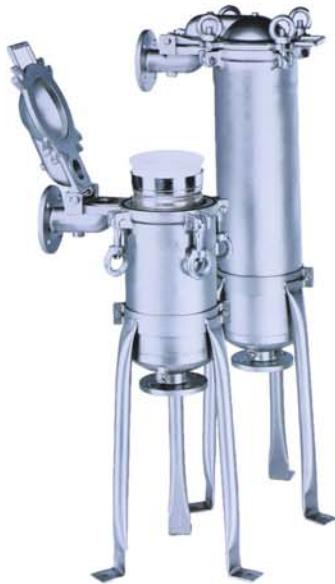
该产品为顶入底出的过滤方式，工作时过滤液从高处流向低位，流体不受紊流的影响，充分利用滤袋的过滤效率和使用寿命。闭合时滤器顶盖直接压紧滤袋环口，密封性能更好，操作简单。整体铸造而成的滤器顶盖螺栓紧固，可以承受更高的压力，设计上满足ASME和CE标准。
